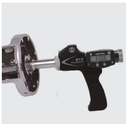
Mesure avec système XT3H à pistolet
