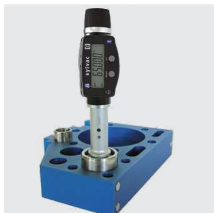
Mesure avec système XT3D à rochet
