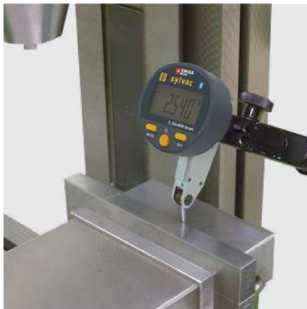
Vérification de l'alignement d'un étou de fraiseuse
